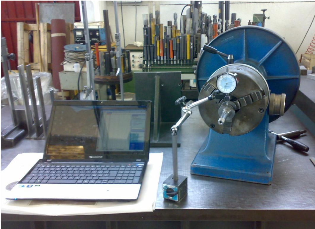
Divisore e comparatore utilizzati per rilevare i dati
